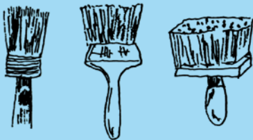
De gauche à droite : brosse algérienne, brosse à plafond et brosse alsacienne
